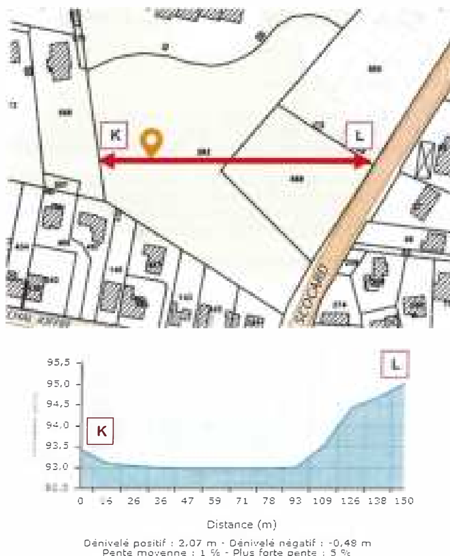
Parcelle n°3, profil altimétrique O-E, source : géoportail
